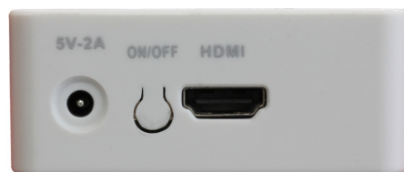
Рис. 7.2: Вид адаптера спереди. Слева направо: разъём питания , кнопка включения питания , разъём HDMI
