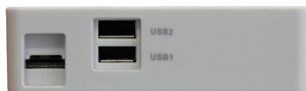
Рис. 7.3: Вид адаптера справа. Слева направо: разъём для микро-SD карты , два разъёма USB
