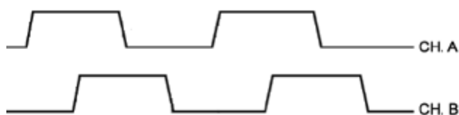
Рис. 4.32: Сигналы на выходе CH A и CH B квадратурного энкодера
